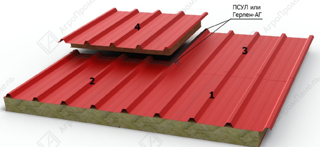
Рис. 6. Порядок укладки кровельных сэндвич панелей
